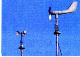
圖(一)：風標和風速計：左邊為杯型風速計，右邊為螺旋槳風向風速計，可以同時測量風向和風速。
