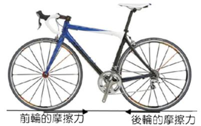
(2) 後輪前進時，帶動前輪前進，因此地面給前輪向後的摩擦力，所以前輪受到的摩擦力方向向後，此摩擦力亦為靜摩擦力。
